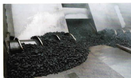
Гранулометрическая сегрегация в бункере Vogele MT 3000-2 Offset
