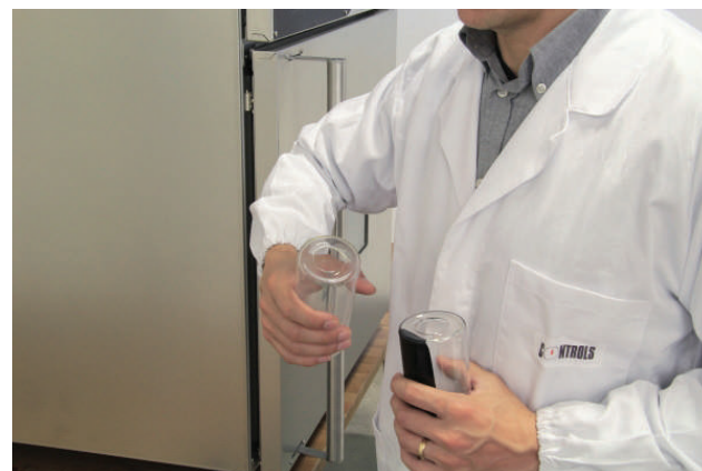
Система блокирования двери, позволяющая легко открывать дверь при занятых руках
